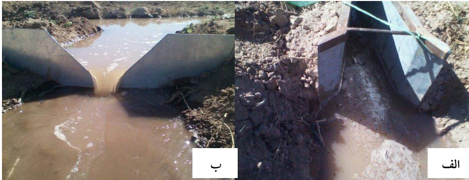
شکل ۱. الف) نحوه اندازه‌گیری دبی ورودی؛ ب) دبی خروجی در جویچه‌های مورد مطالعه
